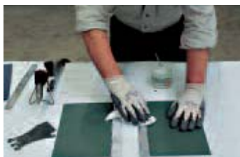
Enlèvement de la couche de prépatinage avec un chiffon sec.
