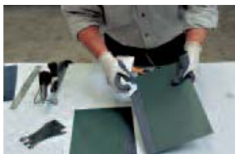
Nettoyage de la zone à soudo-braser avec un chiffon sec.
