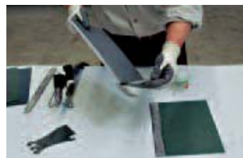
Décapage de la partie inférieure de l'élément supérieur. Deuxième décapage au DECA-VM ZINC (ne pas essayer).
