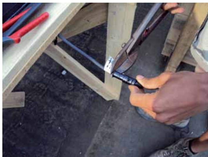
Découpe de l'embout Yukita sur le module
